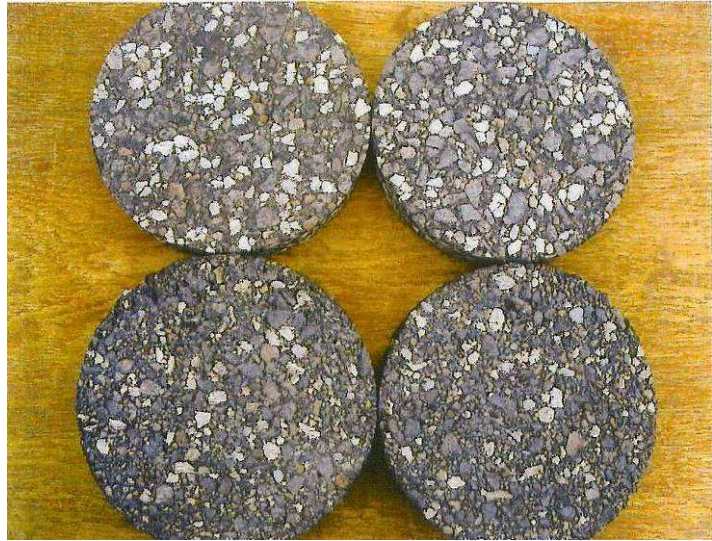
Bild 1: Oben: Bohrkerne der Deckschicht B 501. Unten: Neue Probekörper, aus aufgeschmolzenem Mischgut der B 501 hergestellt. Jeweils links unbehandelt, rechts sandgestrahlt (entnommen [19])
